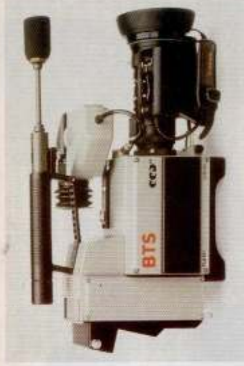
Bild 3. „Electronic News Gathering“-Kamera (ENG) mit drei Frame-Transfer-CCD-Chips in Verbindung mit einem mechanischen Verschluss, wodurch ein völlig smear-freies Bild erzeugt wird. Zur Auftrennung der Farben Rot, Grün und Blau dient ein Farbprisma.
